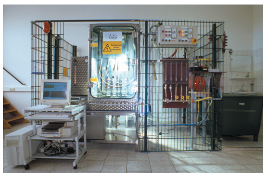
Cabine for 5000h accelerated weather ageing test / Kabine für den 5000h beschleunigten Alterungstest
