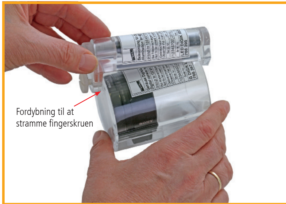
Figur 6 Sæt LED-lygtehuset på kamerahuset
