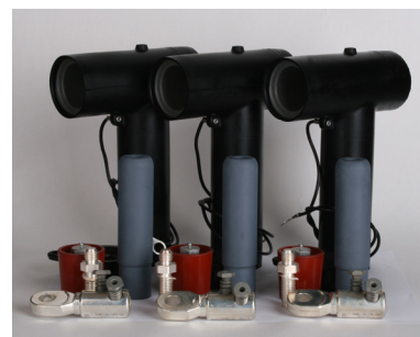
Vinkelstik type K430TB/G til 1-leder kabler op til 24 kV, sæt á 3 stk. med skruekabelsko
