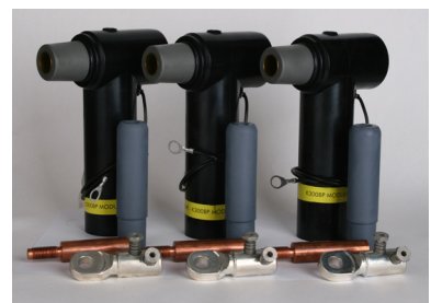
Koblingsstik type 300PBM/G til 1-leder kabler op til 24 kV, sæt á 3 stk. med skruekabelsko
