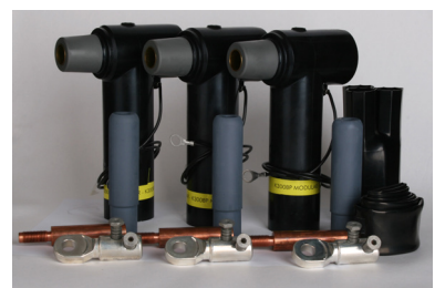
Koblingsstik type 300PBM/G til 3-leder kabler op til 24 kV, sæt á 3 stk. med skruekabelsko og kværkkrympesæt
