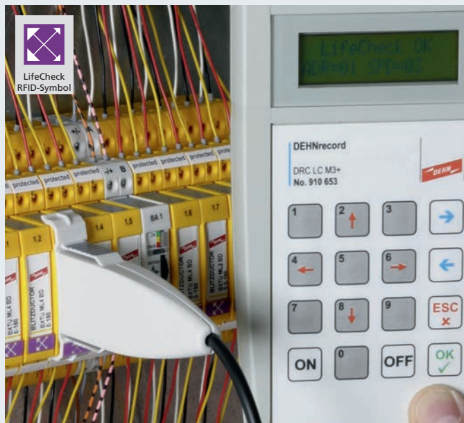
Test af et afledermodul via RFID teknologi (LifeCheck)
